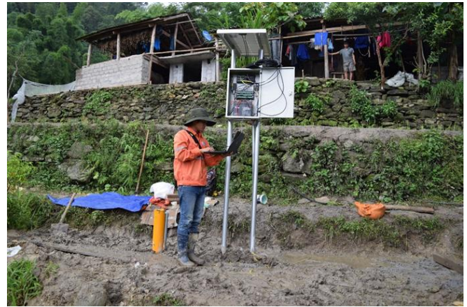
Hình 10. Cài đặt hiệu chỉnh tín hiệu quan trắc cho hệ thống
