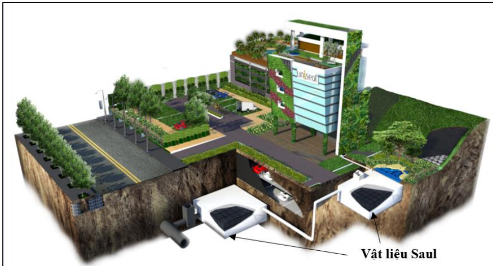
Hình 9. Minh họa quản lý nước mưa thông minh (LCPC và cộng sự, 1998).
