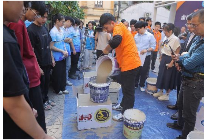
Hình 6: Rót cát để xác định tải trọng tác dụng lên kết cấu tường tường chắn đất có cốt đã được sinh viên xây dựng
