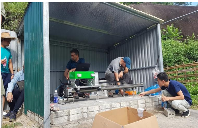
Hình 3. Quan trắc khối trượt lớn Năm Dăn, Xín Mần bằng công nghệ CB-InSAR
