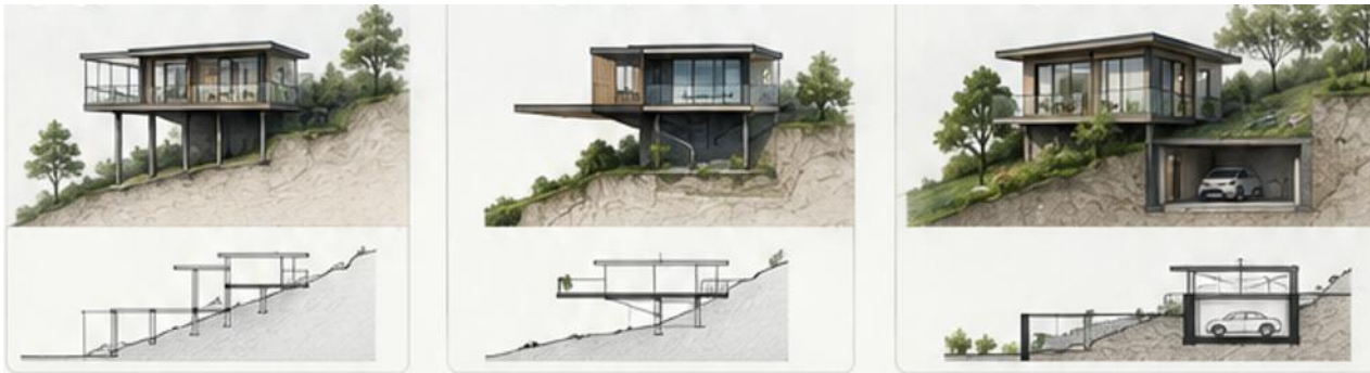
Hình 6. Các giải pháp kết cấu giúp giảm thiểu việc đào đắp đất đá (sử dụng hệ cột, dầm consol, làm tầng hầm)
