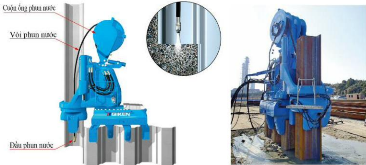
Hình 2. Phương pháp Press-in dạng phun tia nước cao áp.
