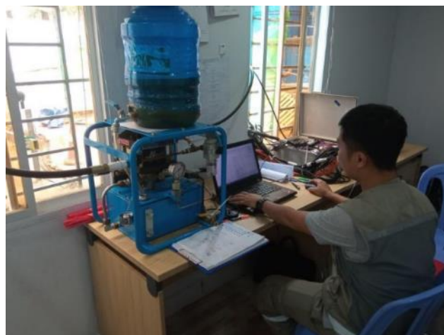
Hình 7. Phòng quan trắc và thí nghiệm tự động, toàn bộ công tác gia tải, kích, quan trắc được thực hiện tại phòng quan trắc
