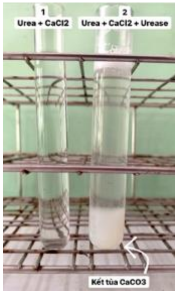
Hình 3. Kiểm tra kết tủa CaCO 3 trong ống nghiệm
