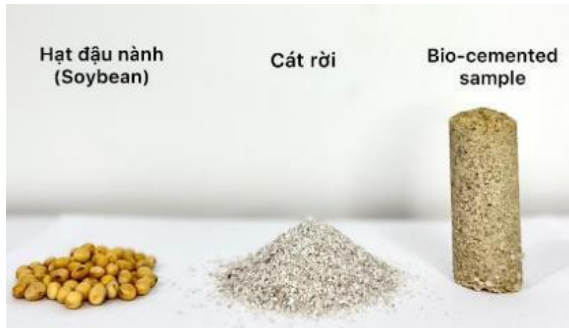
Hình 7. Mẫu cát đã được hóa rắn bằng xi măng sinh học
