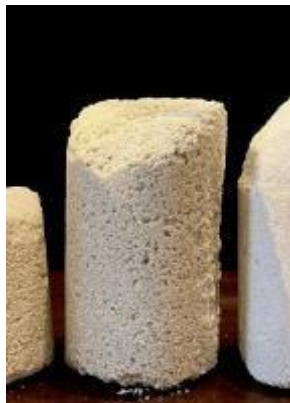
Hình 10: Mẫu cát được liên kết bằng xi măng sinh học
