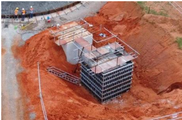
Hình 5. (a) Thí nghiệm Mockup lớn; (b) So sánh nhiệt độ giữa thực tế và mô phỏng
