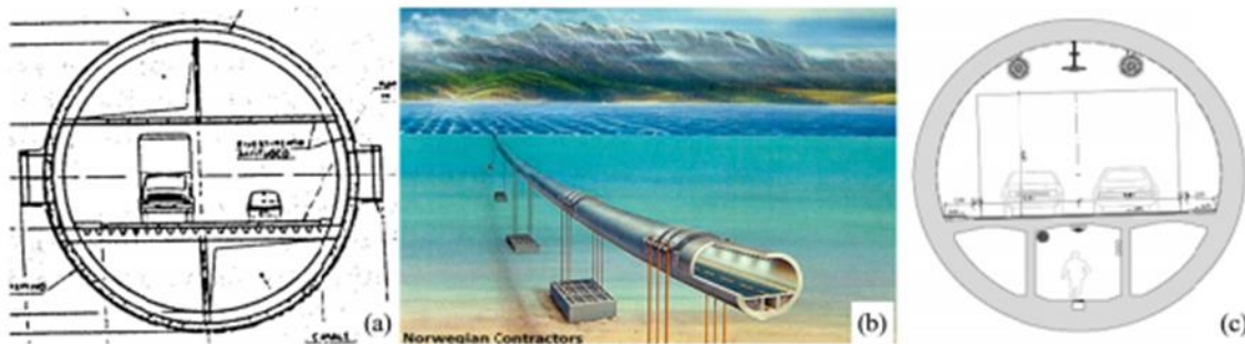
Hình 5. Hầm nổi (hầm trong nước); (a) vượt sông Messina. Ý (theo Scolari et al., 1989), (b) Vượt Hogsjord, Na Uy (theo Skorpa, 2001), (c) vượt Sulaffjord, Na Uy (theo Jakobsen et al, 2009)
