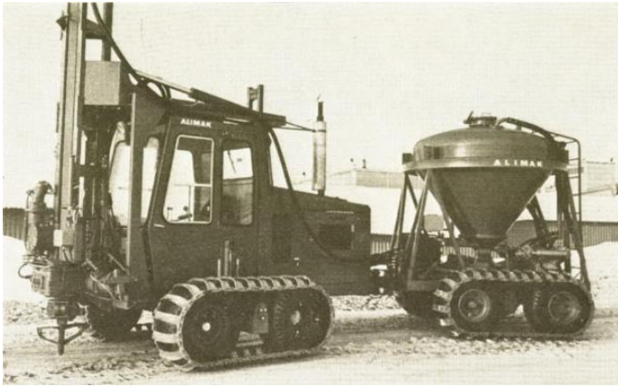
Hình 1. Máy thi công trộn đất vôi Linden-Alimax LPS-3 do Thụy Điển viện trợ cho Việt Nam
