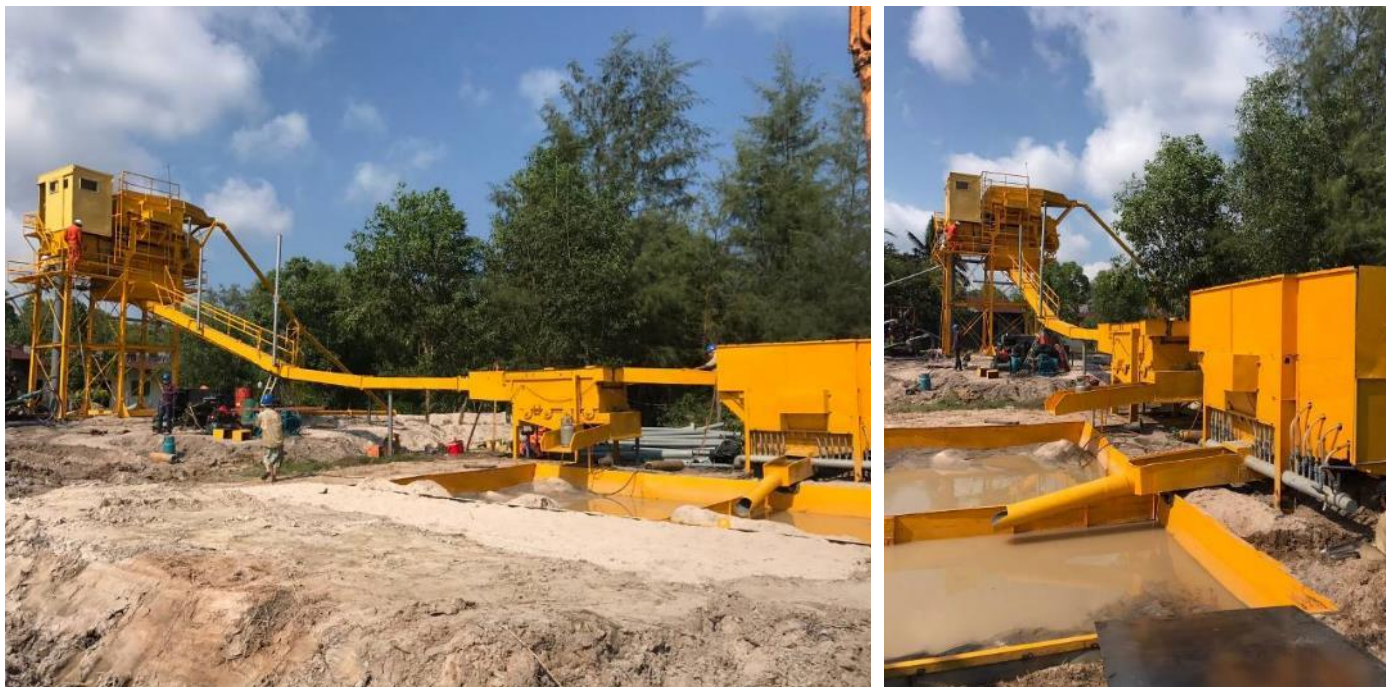
Hình 1 Hệ thống thiết bị tuyển rửa cát biển nhiễm mặn đã được lắp đặt và khai thác tại Phú Quốc, Kiên Giang
