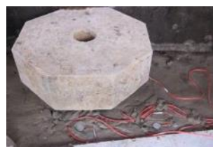
Cảm biến ứng suất kích thước nhỏ (D=20mm) đo ứng suất của đất nền dưới khối móng
