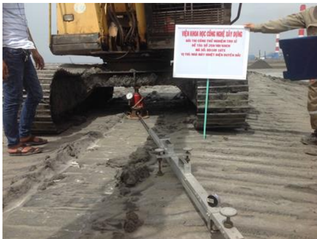
Hình 1. Thí nghiệm khối đắp đất fly ash tại nhiệt độ điện Duyên Hải của IBST
