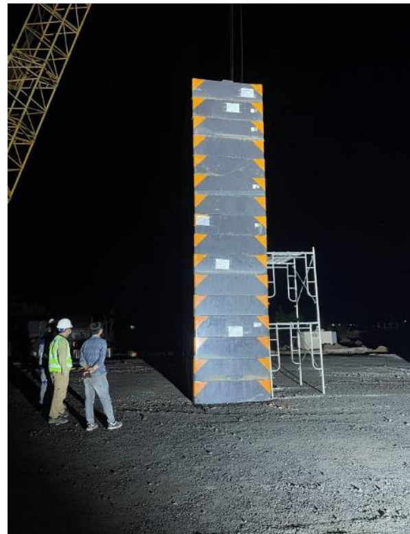
Hình 8. Hình ảnh thi công sàn cầu và thử nén tĩnh sàn cầu với tải trọng 40T/m 2
