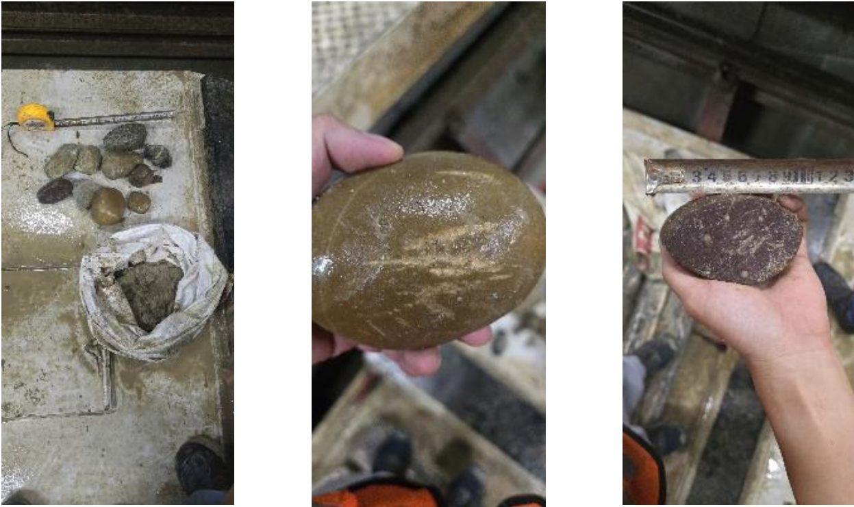
Hình 15. Một số cuội sỏi thu được từ lớp GU7&8 tại độ sâu khoảng 25 m
