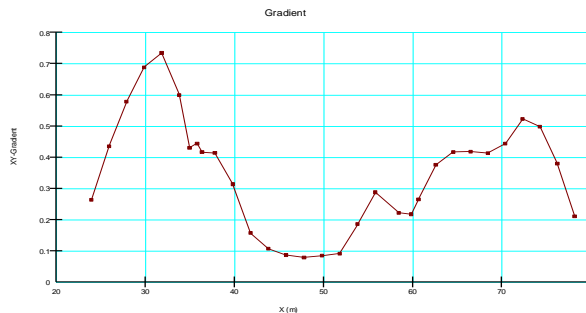
Hình 10. Gradient thủy lực dòng thấm tại vị trí dưới đáy ụ
