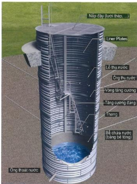
Hình 5. Giếng thu nước sử dụng Liner Plates [2]
