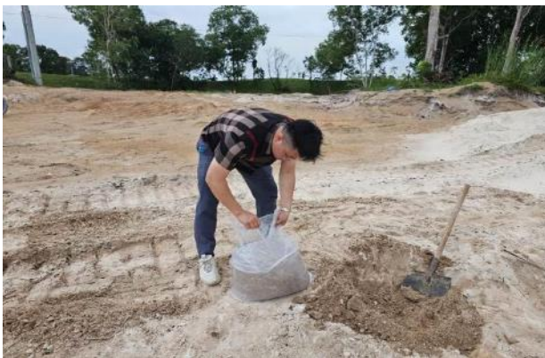
Hình 4. Lấy vật liệu thí nghiệm trước khi thi công
