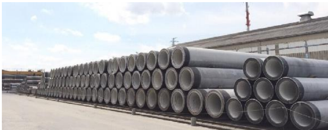
Hình 7: Cọc ống bê tông cốt thép ly tâm dự ứng lực đường kính lớn
