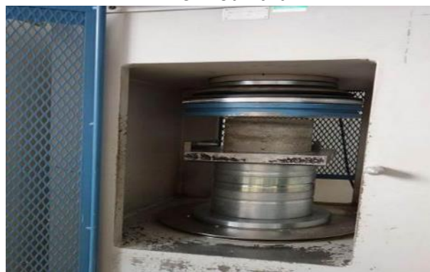
Hình 17. Thí nghiệm nén mẫu khoan tại hiện trường
