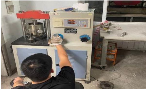
Hình 6. Nén mẫu vật liệu trước khi thi công
