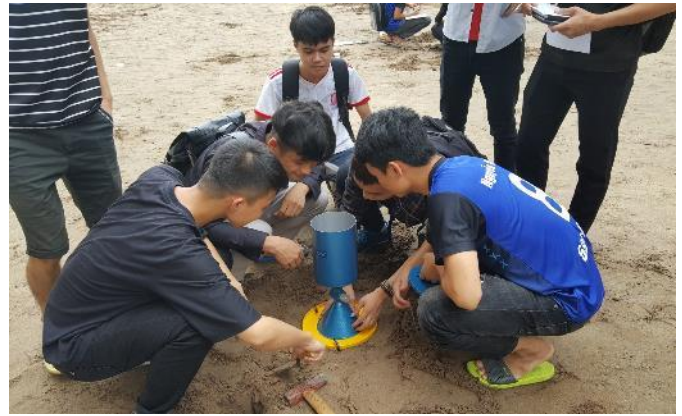
Hình 5. Sinh viên thực tập công tác khoan khảo sát và thí nghiệm kiểm tra độ chặt hiện trường
