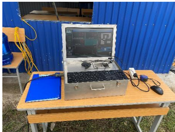
Hình 9. Thí nghiệm mô hình vật lý khoan phụt xử lý thấm tại bãi thực tập dành riêng cho ngành Địa kỹ thuật (hình trái); thiết bị đo đạc kết nối tự động thí nghiệm mô hình (hình phải)
