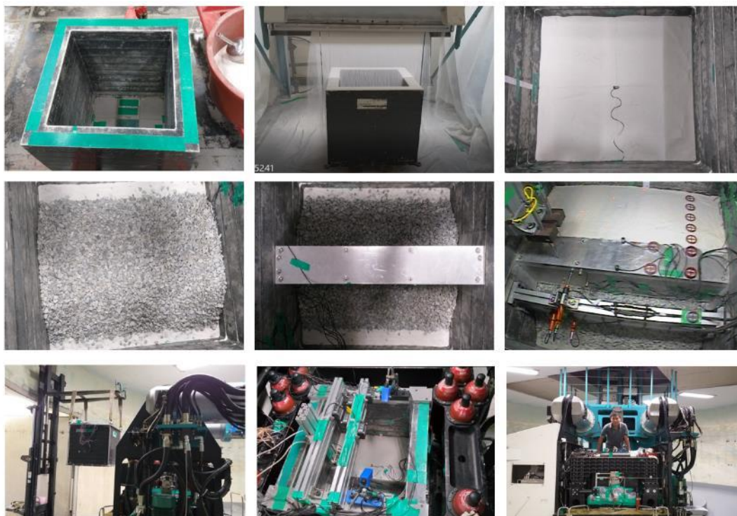
Hình 7. Chế tạo và lắp đặt mô hình trên máy ly tâm
