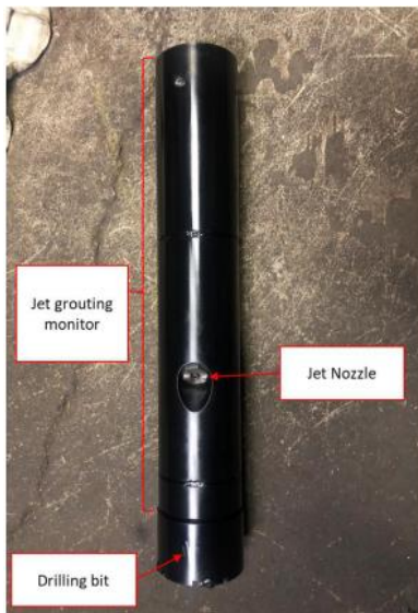
Hình 9. Thiết bị đầu phụt đã được cải tiến
