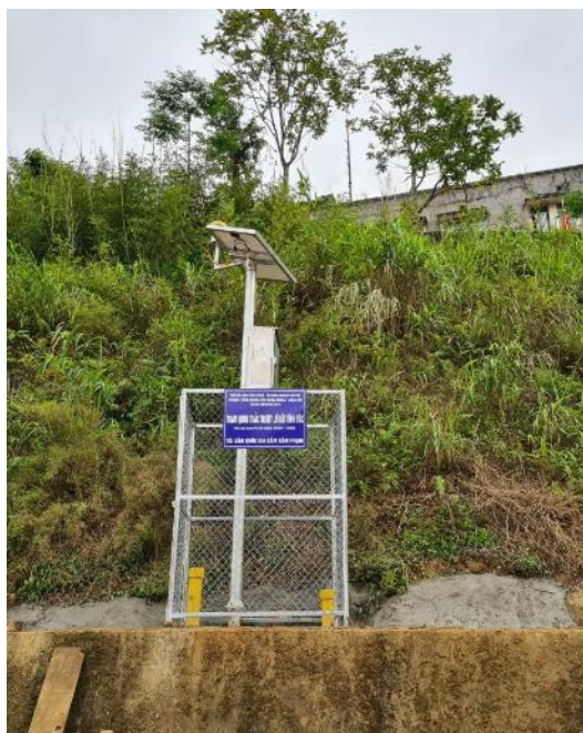
Hình 10. Thí nghiệm hộp cắt cỡ lớn xác định độ bền kháng cắt của tại hiện trường vật liệu đá (hình trái); trạm quan trắc cảnh báo trượt lở tại Tỉnh Túc-Cao Bằng do bộ môn Địa kỹ thuật lắp đặt (hình phải).
