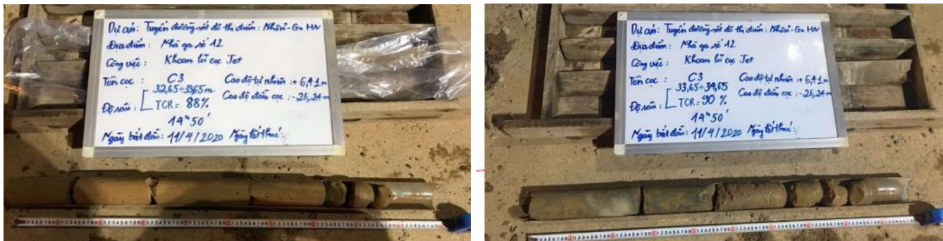
Hình 5. Lỗ khoan tại hiện trường: (Trái) Phần mẫu trên; (Phải) phần mẫu dưới
